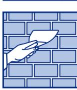
Расшивку и очистку наружных и внутренних поверхностей кладки от излишков раствора рекомендуется производить во время выполнения кладочных работ, либо сразу после их окончания. Необходимо уделить особое внимание каналам и дымоходам. Они должны быть тщательно очищены и иметь максимально гладкую внутреннюю поверхность.
