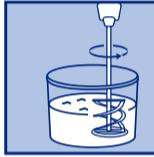
Сухую смесь смешать с чистой водой, температурой от +15 до +18°C в соотношении 0,27 – 0,32 л на 1 кг смеси (4,86-5,76 на мешок 18 кг) до получения однородной массы без комков. Полученную растворную смесь выдержать 3 – 5 мин, а затем повторно перемешать. Избыток воды приводит к снижению прочностных характеристик раствора! Приготовленный раствор можно использовать в течение 2 часов.
