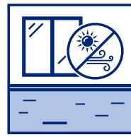
При проведении работ и в период твердения, избегать сквозняков и не допускать попадания прямых солнечных лучей на поверхность. Время набора прочности зависит от температуры и влажности.
