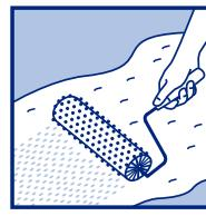
Равномерно залить участки основания, начиная с самой низкой точки, по специальному маякам-реперам до требуемой толщины. Избегать технологических перерывов в процессе работы. Сразу после заливки прокатать слой игольчатым валиком, чтобы удалить пузырьки воздуха для получения более гладкой поверхности.
