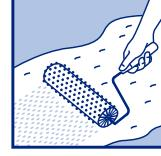
Равномерно залить участки основания, начиная с самой низкой точки, по специальным маякам-реперам до требуемой толщины. Избегать технологических перерывов в процессе работы. Сразу после заливки прокатать слой игольчатым валиком, чтобы удалить пузырьки воздуха для получения более гладкой поверхности.
