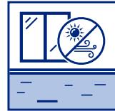
При проведении работ и в период твердения, избегать сквозняков и не допускать попадания прямых солнечных лучей на поверхность. Время набора прочности зависит от температуры и влажности.
