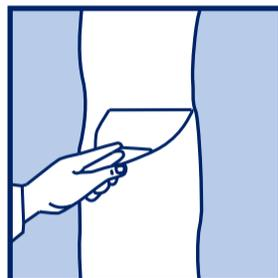
Готовую шпаклёвочную смесь наносят на поверхность при помощи шпателя ровным слоем толщиной до 2-х мм. Перед нанесением следующего слоя необходимо убедиться в том, что предыдущий слой высох. Время высыхания зависит от толщины слоя, влажности и температуры.
