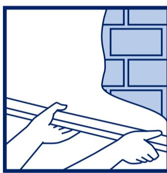
Готовую штукатурную смесь нанести на поверхность набросом или намазыванием и затем разровнять при помощи полутёрка или правила. Толщина одного слоя при выравнивании стен **5-50 мм**, при выравнивании потолков **5-15 мм**. Подрезку нанесенного слоя штукатурки необходимо выполнить, когда раствор начнет схватываться (**через ~30 мин.** после затворения).
