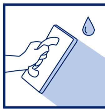
Спустя **15-25 минут** после подрезки поверхность затереть губчатой (войлокной) теркой, обильно смоченной водой, заполняя все оставшиеся неровности в нанесенном слое. После небольшой выдержки до появления "матовости" на поверхности, загладить штукатурку широким металлическим шпателем.
