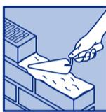
Необходимо нанести растворную смесь при помощи мастерка. Толщина нанесения 5-20 мм. Сильно впитывающие поверхности предварительно увлажнить. Приготовленную растворную смесь можно использовать в течение 1,5 - 2-х часов. Время твердения раствора зависит от толщины шва, температуры и влажности.
