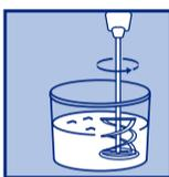
Сухую смесь смешать с чистой водой температурой 15-18°C в соотношении 0,18-0,22 л воды на 1 кг смеси (4,5-5,5 л воды на мешок 25 кг) до получения однородной массы без комков, дать выстояться в течение 3-5 минут и перемешать вторично. Избыток воды приводит к снижению прочностных характеристик раствора!
