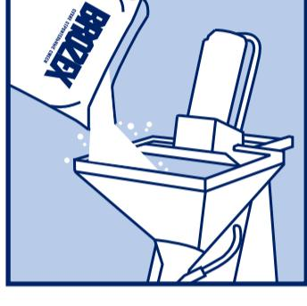
Сухую смесь высыпать в бункер штукатурной станции. Расход воды для перемешивания установить в зависимости от требуемой консистенции растворной смеси.
