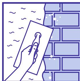
Готовую штукатурную смесь нанести на поверхность набросом или намазыванием. Толщина нанесения 10-15 мм, при частичном выравнивании до 25 мм.
