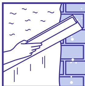
Затем разровнять при помощи полутёрка или правила.
