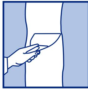
Готовую шпаклевочную смесь наносят на поверхность при помощи шпателя ровным слоем толщиной до 1 мм. Перед нанесением следующего слоя необходимо убедиться в том, что предыдущий слой высох. Время высыхания зависит от толщины слоя, влажности и температуры.
