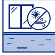
При проведении работ и в период твердения необходимо избегать сквозняков, не допускать попадания прямых солнечных лучей на поверхность уложенного раствора. Время набора прочности зависит от температуры и влажности.
