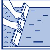
Готовую растворную смесь нанести на основание и разровнять при помощи металлической линейки или правила. Для окончательного выравнивания и разглаживания использовать шпатель. Выравнивание основания следует производить в один слой по маякам, которые устанавливаются по уровню, с шагом 1,5-2 м. Толщина слоя при внутренних работах 5-60мм, при наружных работах 20-60мм.
