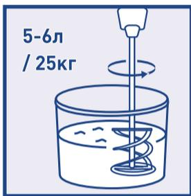
Сухую смесь смешать с чистой водой температурой от +15 до +18°C в соотношении 0,20-0,24 л воды на 1 кг смеси (5,0 - 6,0 л на мешок 25 кг) до получения однородной массы без комков, дать выстояться в течение 3-5 минут и перемешать вторично. Приготовленный раствор можно использовать в течение 3-х часов.
