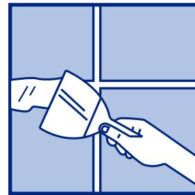
Швы между плитками заполнить затирочными смесями **BROZEX КАНТ**. Работы проводить не ранее, чем через **9 часов** после укладки плитки на стенах, и не ранее **16 часов** — на полах.
