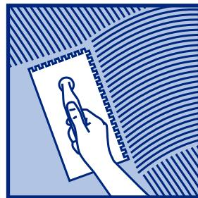
Полученную растворную смесь нанести тонким слоем при помощи лопатки. Затем выровнять зубчатым шпателем. Зубцы шпателя должны соответствовать размерам плиток (**15x15 см — зубцы 6 мм, 30x30 см — 8 мм, 60x60 — 12 мм**).
