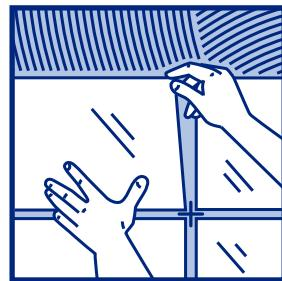
Плитки следует уложить в течение **15-20 минут** после покрытия основания раствором. **Плитки предварительно не замачивать!** Не рекомендуется укладывать плитки «встык». Ширина шва должна быть **не менее 2 мм**. Швы при укладке плитки должны оставаться свободными. Для удобства необходимо использовать крестики. Излишки растворной смеси удалить. Приготовленный раствор можно использовать **в течение 4-х часов**.
