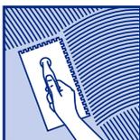
Полученную растворную смесь нанести тонким слоем при помощи лопатки. Затем выровнять зубчатым шпателем.
