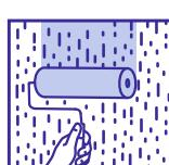
Последующая окраска поверхности возможна только после полного высыхания штукатурного покрытия, но не ранее чем через 72 часа после нанесения.
