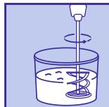
Сухую смесь смешать с чистой водой, температурой от +15 до +18°C, в соотношении 5,25-6,5 л на мешок 25кг до получения однородной массы без комков. Полученную смесь выдержать 5-10 минут, а затем повторно перемешать. Приготовленный раствор использовать в течение 2 часов.
