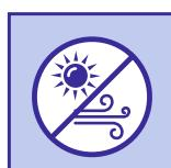
В период проведения работ, а также во время твердения декоративной штукатурки, поверхность необходимо оберегать от попадания прямых солнечных лучей, пересыхания, воздействия ветра и атмосферных осадков. Время высыхания штукатурки зависит от основания, температуры и относительной влажности воздуха и составляет 12 – 72 часа.
