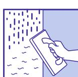
Формирование бороздчатой структуры «Короед» следует начинать при помощи пластиковой терки спустя 5 – 15 минут с момента нанесения. Интервал между нанесением штукатурки и структурированием зависит от поглощающей способности основания, температуры окружающей среды и консистенции раствора.
