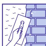
Готовый раствор нанести на поверхность с использованием стального шпателя или кельмы. Рекомендуемая толщина слоя 4 – 5мм.
