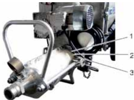
Рис. 11: Монтаж шнекового насоса с фиксатором от проворота
