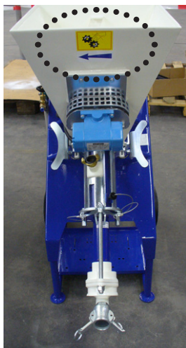
Рис. 6а. Предписанное направление вращения двигателя
