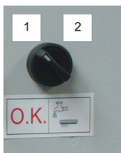
Рис. 6с. Положения переключения для переключателя «Водяной насос»
